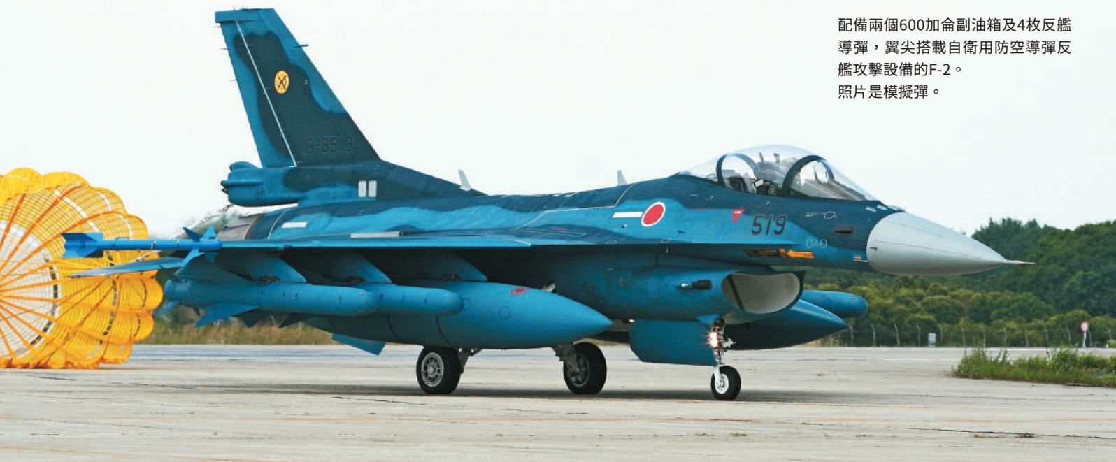
配備兩個600加侖副油箱及4枚反艦導彈，翼尖搭載自衛用防空導彈反艦攻擊設備的F-2。
