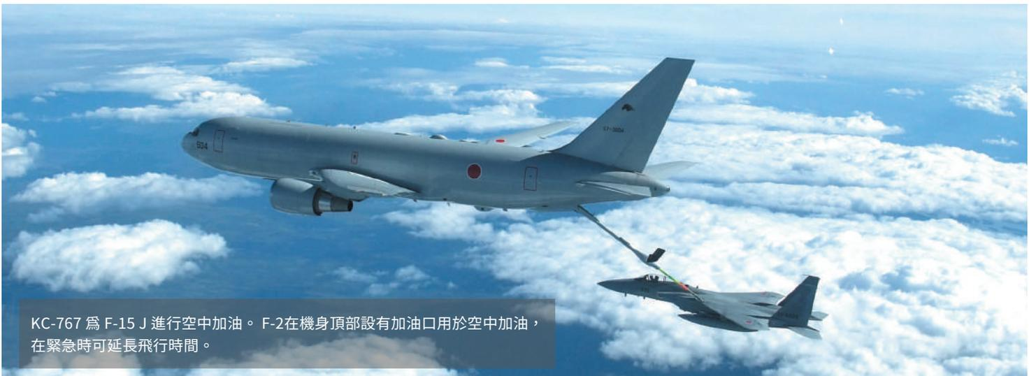
KC-767 為 F-15 J 進行空中加油。F-2在機身頂部設有加油口用於空中加油，在緊急時可延長飛行時間。
